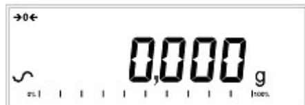
当水份分析仪稳定后屏幕将显示稳定符号~。在不稳定的情况下符号将不显示。当水份分析仪处于零点时在屏幕左上方将显示符号“ $\rightarrow 0 \leftarrow$ ”
